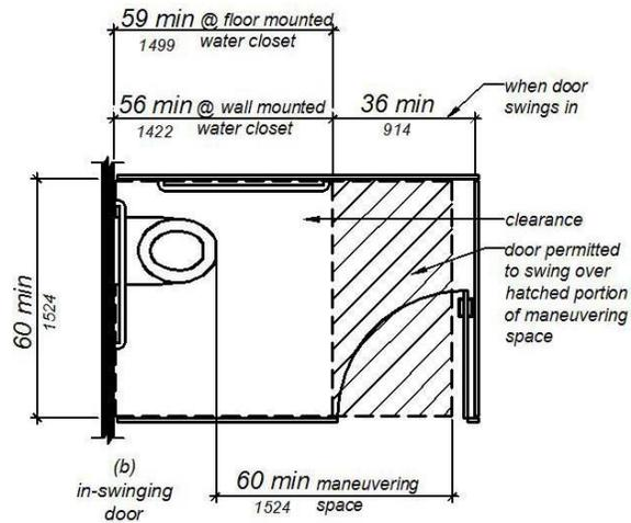
**FIGURE 11B-604.8.1.1.2 - MANEUVERING SPACE WITH SIDE-OPENING DOOR**
